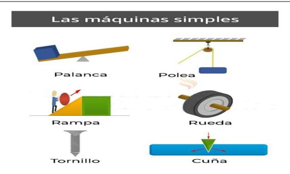
La palanca: Es una barra rígida con un punto de apoyo, a la que se aplica una fuerza y que, girando sobre el punto de apoyo, vence una resistencia. Una de estas palancas es el Plano inclinado; Es una superficie inclinada con un cierto ángulo sobre la horizontal, utilizada para levantar grandes pesos con poco esfuerzo.
